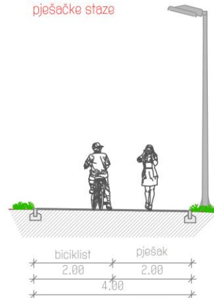
PRESJEK F biciklističke i pješačke staze
